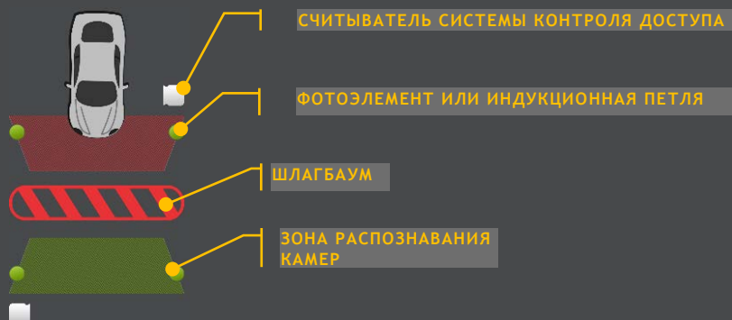
РИСУНОК 45: ОБОЗНАЧЕНИЯ НА СХЕМАТИЧЕСКОМ ИЗОБРАЖЕНИИ КПП
